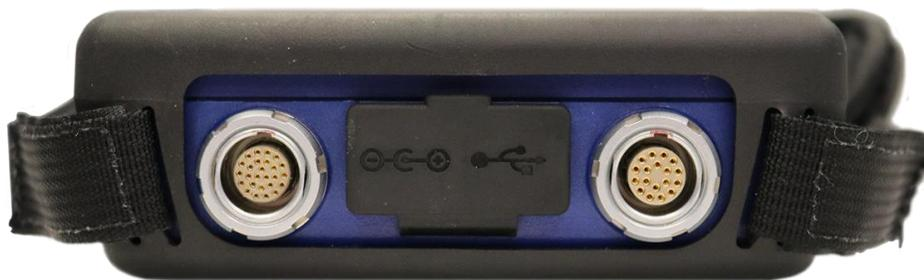
26 pin для матричных датчиков    18Pin для портативных и вращающихся сканеров
