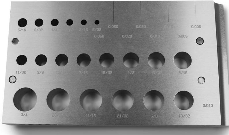
Стандартный набор эталонов для ВТК на флоте военно-морских сил. Содержит 20 отверстий для креплений (.156–.750), всего 71 пропил EDM. Включает протокол испытаний и сертификат соответствия.
